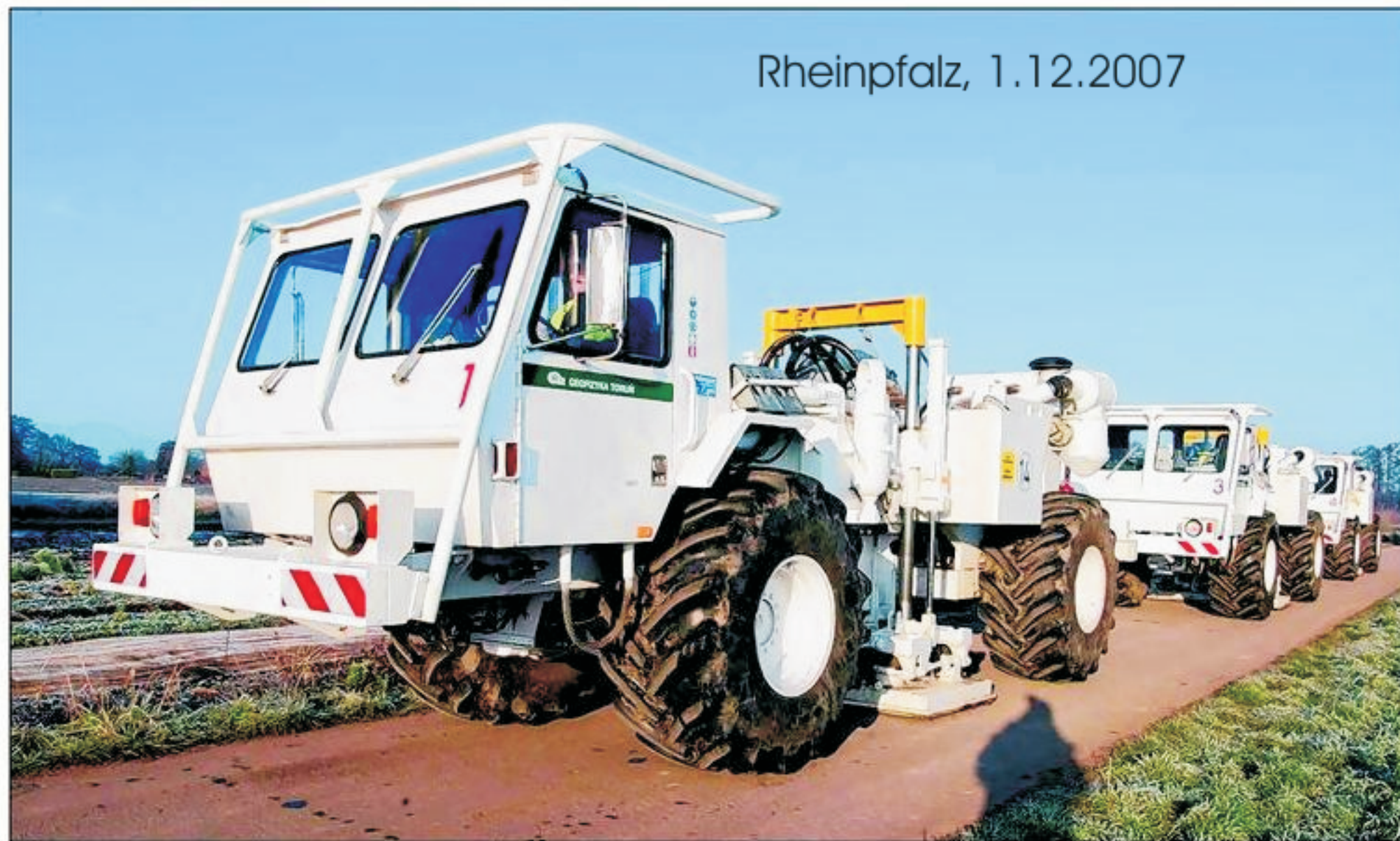
20 Tonnen wiegen die Fahrzeuge, die mittels Rüttelplatten Schallwellen in den Boden senden.
